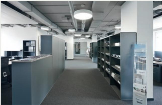
In den Korridorzonen blieben die Decken offen, sie wurden mit frei angeordneten Pendelleuchten versehen. Über den Arbeitsplätzen hingegen wurden aufgrund akustischer Überlegungen Deckensegel aufgehängt.
